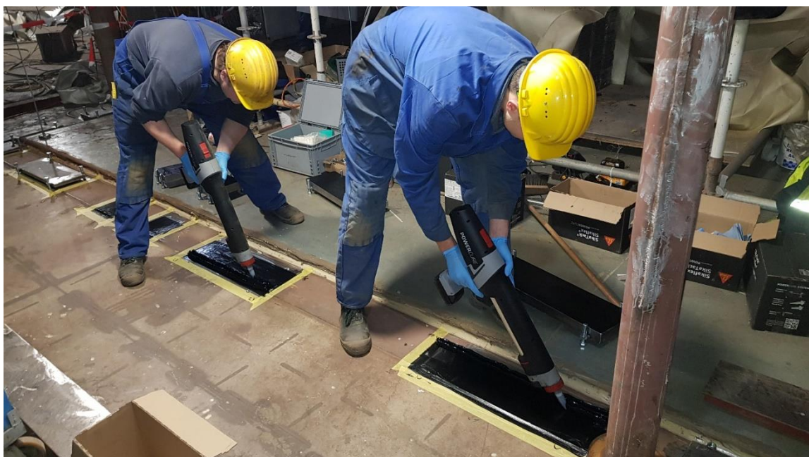
Abbildung 1: Manuelles Kleben im Schiffbau ist häufig körperlich schwierig und nicht immer fehlerfrei (Quelle: Meyer Werft)
