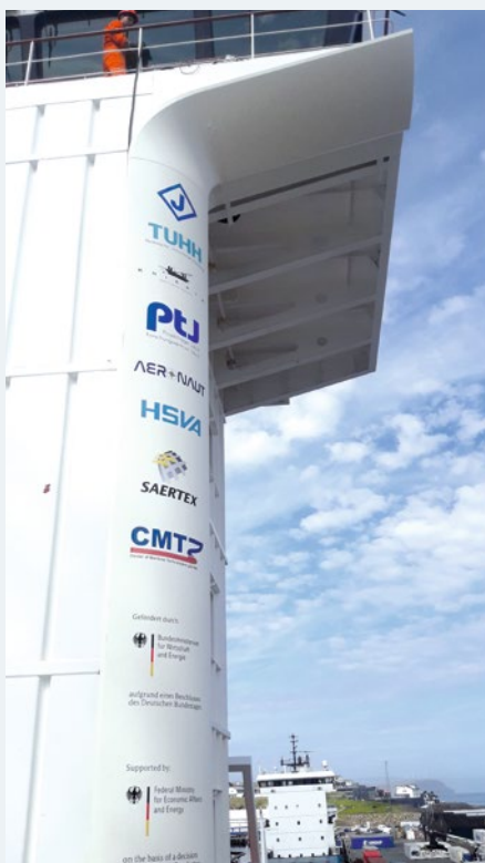
Die aerodynamischen Leitbleche wurden zu Testzwecken an den Aufbauten der „Pictor J“ der Reederei Jüngerhans angebracht
