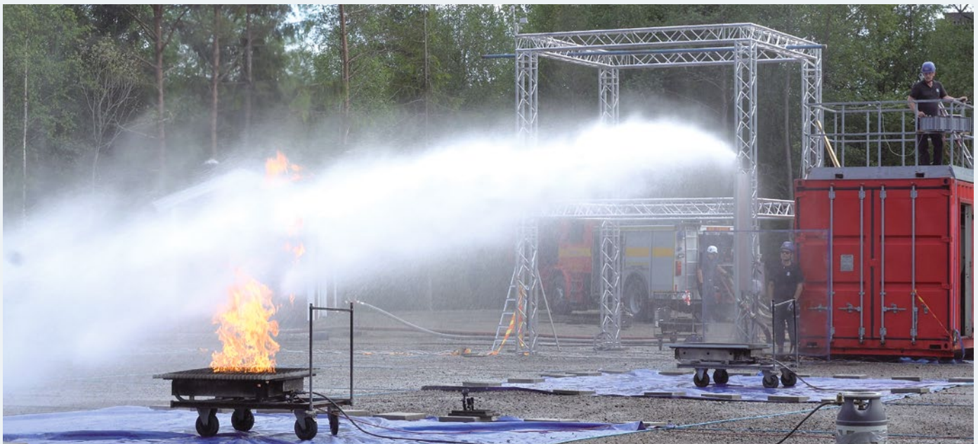
LASH FIRE-Partner testen das vollständig autonome Brandschutzsystem FlameRanger
